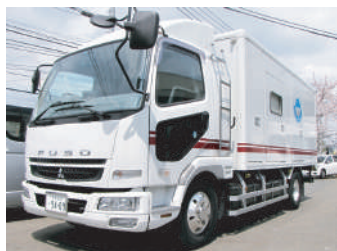
260KVA サイレントゼネ 4t (無停電システム可)
